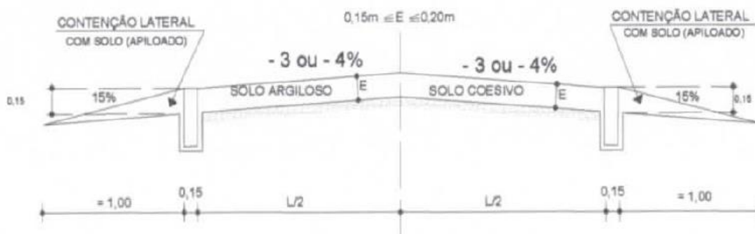
Figura 12: Colchão de Solo
